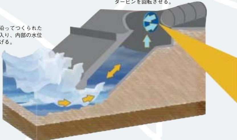
タービンは水が室内へ入る時も海に戻る時も回転する。タービンの動きで発電機を駆動し、電力が発生する。
