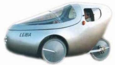
健康的な自転車と雨露をしのぐ車体とを併せ持ち、ペダルを踏む時、横たわった姿勢になる。ペロモービルは前方に足を投げ出し後ろに寄りかかって乗る自転車で、ファイバーガラス、あるいはその他の素材製のポッドの中に乗り手をすっぽり閉じ込め、平地では最高時速48キロのスピードで風を切って走る。ヨーロッパや北米で次第に人気を集めつつある。
