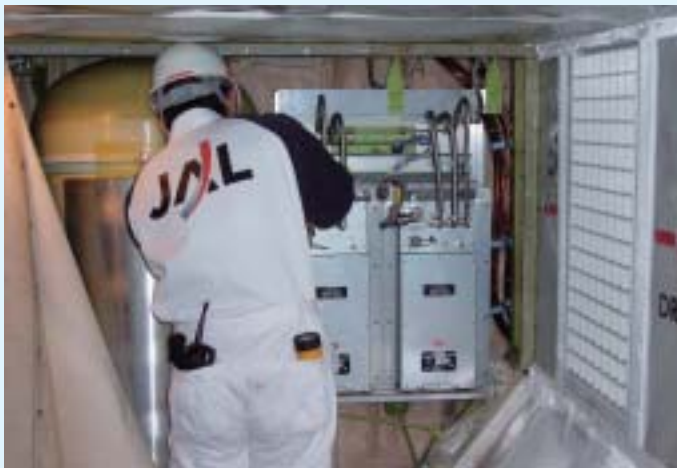
自動大気採取装置の貨物室への取付け
